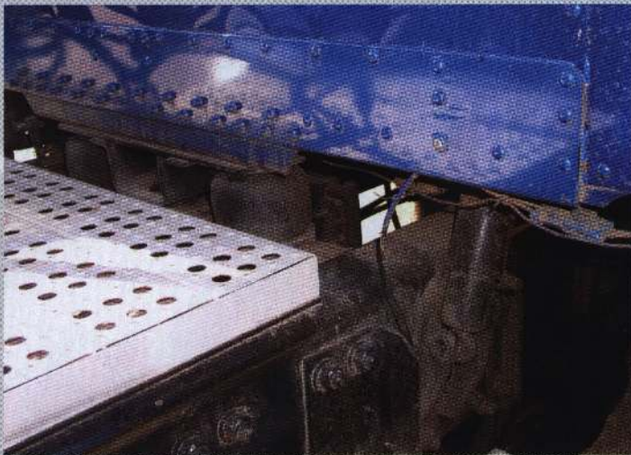
Подвеска кабины: спереди – резиновые проставки, сзади – пневмобаллоны и амортизаторы
