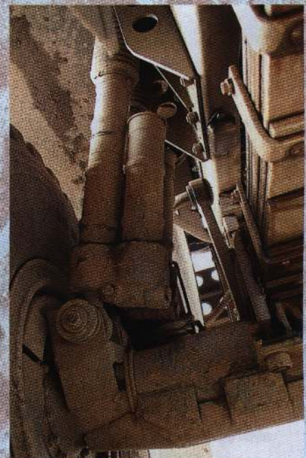
На каждый мост устанавливаются 4 гидравлические стойки со остроумными амортизаторами с прогрессивной характеристикой сжатия газа от боевой машины десанта. Прежде чем поставить их на машину, стойки перебираются с заменой резинок и сальников. На заднем мосту грузовика они установлены «верх ногами» относительно стоек переднего моста
