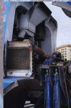
Как и любой гоночной машине, КамАЗу требуются значительные площади обдува радиаторов, поэтому воздухозаборники теплообменников расположены на кабине в больших количествах
