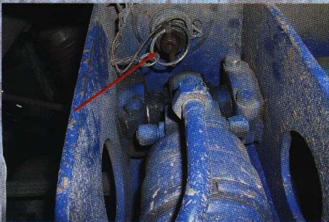
Так как обычные замки на гоним не спасут кабину от опрокидывания, приходится жестко крепить ее болтами с гайками
