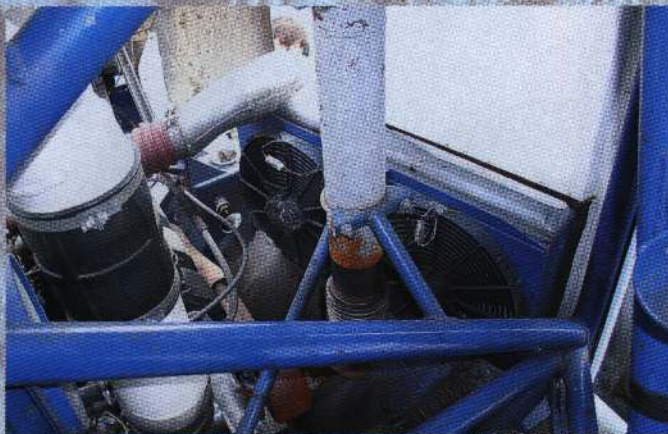
После воздушных фильтров воздух попадает в теплообменник (для каждой турбины отдельный), где охлаждается. По два электрических вентилятора для каждого радиатора принудительно прогоняют воздух через соты. После чего охлажденный воздух поступает в цилиндры
