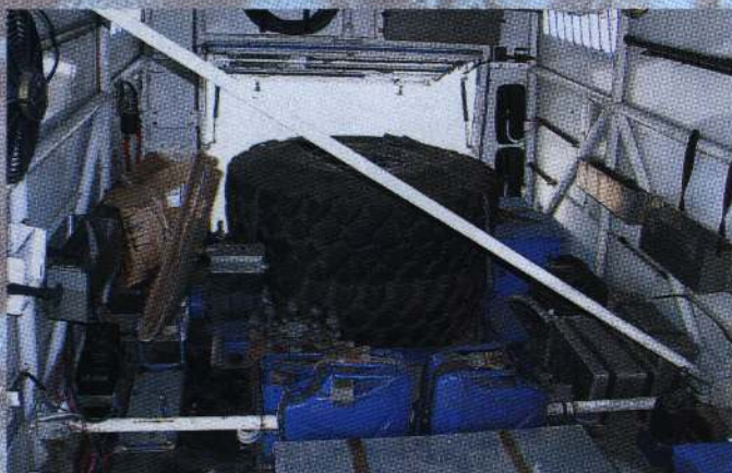
Внутри фургона расположены запасные части, два колеса и инструмент для ремонта, включая пневматический гайковёрт, который подключается к ресиверу
