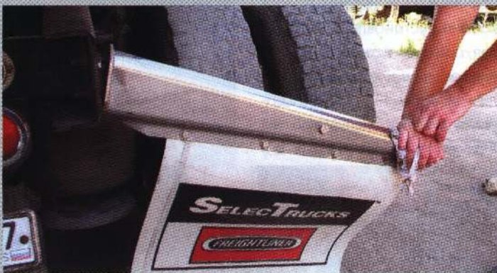
Кормовые габаритные фонари грузовика встроены в задний поперечный лонжерон рамы, брызговики отгибаются
