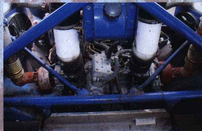
Ярославский 8-цилиндровый двигатель устанавливается на военную технику. 2 импортные турбины и 4 клапана на цилиндр позволяют существенно повысить его мощность. Через каждые 2 — 3 тонны двигатель снимается с машины и отправляется на завод для диагностики. До 2001 г. эти двигатели устанавливались на спортивном КамАЗе в базе машины. После изменения правил мотор врезывал под кабину
