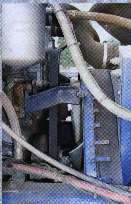
После воздушных фильтров воздух попадает в теплообменник (для каждой турбины отдельный), где охлаждается. По два электрических вентилятора для каждого радиатора принудительно прогоняют воздух через соты. После чего охлажденный воздух поступает в цилиндры
