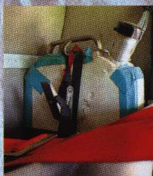
Слева за сиденьем водителя располагается канистра с водой. Через пластиковую трубку, конец которой закреплен над головой, водитель на ходу утоляет жажду
