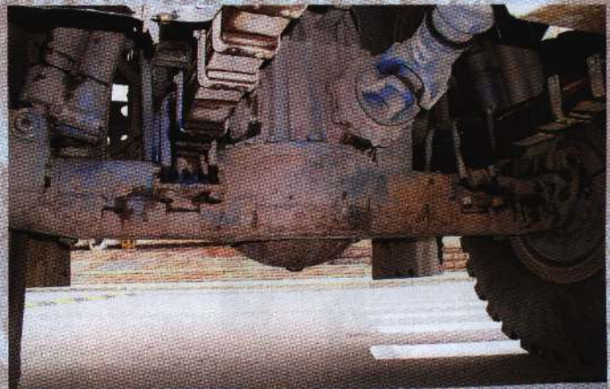
Ведущие мосты – гибридные, собранные из камазовских и кразовских деталей. Карданный вал переднего моста страхуется тросом в случае его обрыва. Поддон картера двигателя с выемкой для кардана
