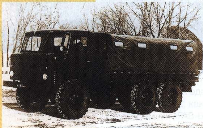
5. 3-осный грузовой автомобиль-вездеход «ГАЗ-34» был растраскирован в нескольких экземплярах и так и не увидел массового производства, став конкурентом «ЗИЛ-131». Фото из архива А.С. Исаева
