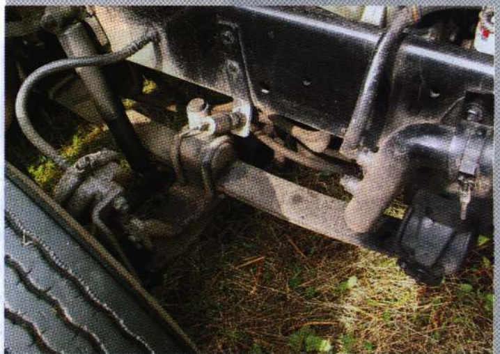
Передняя подвеска. Обратите внимание на мощный ограничитель хода сжатия
