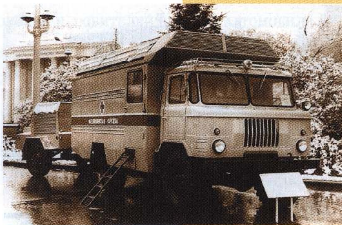
8. Передвижные амбулатории «АВП-3923» на шасси «ГАЗ-6-01» и прицепа «ГАЗП-75» выпускались в 1975-1980 гг. «Ворошиловградским автосборочным заводом». Такие агрегаты были незаменимы в сельской местности. Фото автора
