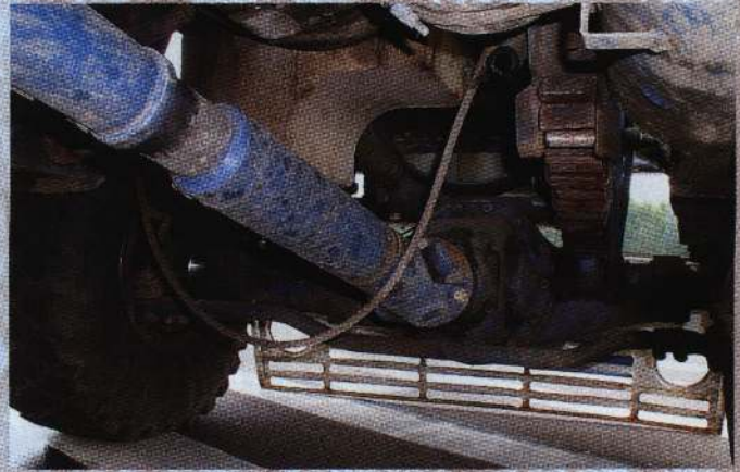
Ведущие мосты – гибридные, собранные из камазовских и кразовских деталей. Карданный вал переднего моста страхуется тросом в случае его обрыва. Поддон картера двигателя с выемкой для кардана
