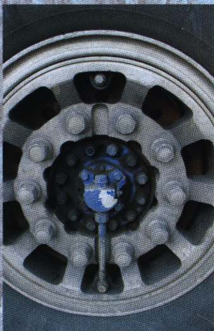
Импортированные шины с централизованной подкачкой не боятся мелких проколов. Манометры давления выведены в кабину. Диски колес алюминиевые и их конструкция позволяет менять покрышку, не снимая колесо со ступицы
