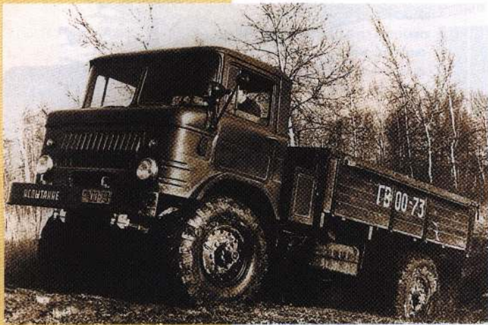
4. Самый первый опытный образец нового автомобиля-вездехода «ГАЗ-66» уже в 1962 году проходил интенсивные испытания по бездорожью. Фото из архива А.С. Исаева
