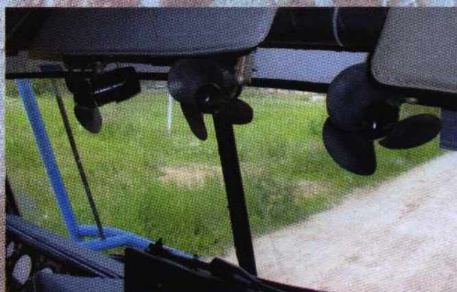
Авиационные вентиляторы над каждым членом экипажа с безопасными резиновыми лопастями лишь отчасти спасают от жары
