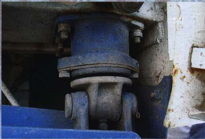
Кабина имеет жесткую подвеску. В роли упругого элемента выступают сайлентблоки
