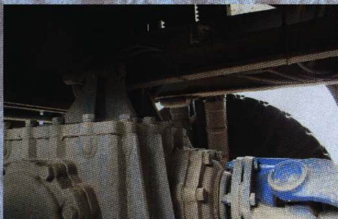
Дополнительная реактивная тяга на крышке картера редуктора защищает мост от скручивания. Но только на заднем мосту. Двигатель под кабиной не позволяет разместить тягу на переднем мосту
