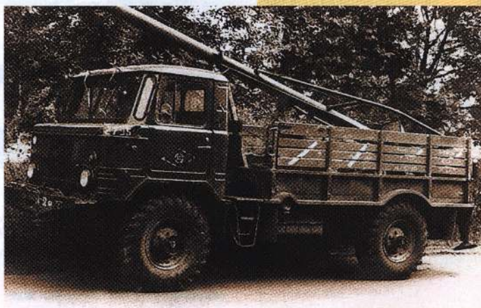
9. Бурильно-крановые машины «БМ-202» на шасси «ГАЗ-66-02» изготавливались алапаевским заводом «Строймаш» в 1970-1985 гг. и эксплуатировались в строительных войсках. Фото автора
