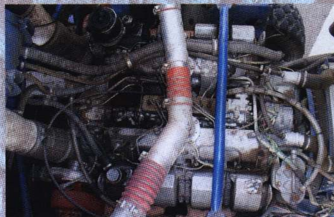
Ярославский 8-цилиндровый двигатель устанавливается на военную технику. 2 импортные турбины и 4 клапана на цилиндр позволяют существенно повысить его мощность. Через каждые 2 — 3 тонны двигатель снимается с машины и отправляется на завод для диагностики. До 2001 г. эти двигатели устанавливались на спортивном КамАЗе в базе машины. После изменения правил мотор врезывал под кабину
