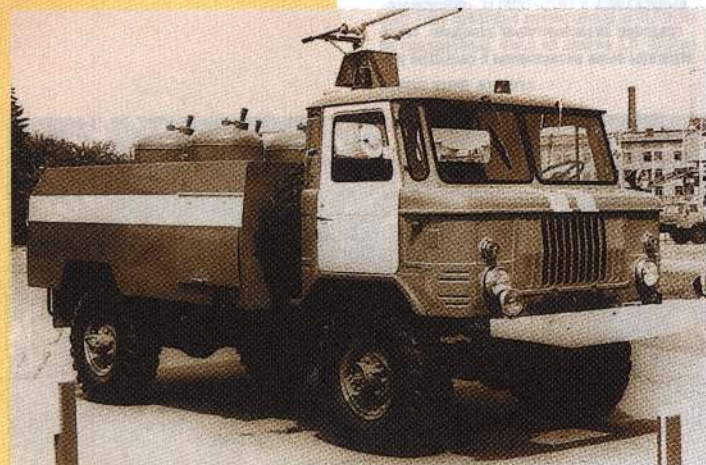
12. Еще один пожарный автомобиль комбинированного тушения «АКТ-0,5(66)» модели «207» на шасси «ГАЗ-66-01» образца 1981 года. Фото автора
