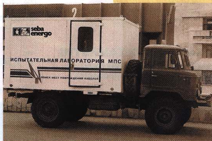
10. Испытательная лаборатория на шасси «ГАЗ-66-02» для поиска поврежденных телефонных кабелей, оборудование немецкой фирмы Seba, 1993 год. Фото автора
