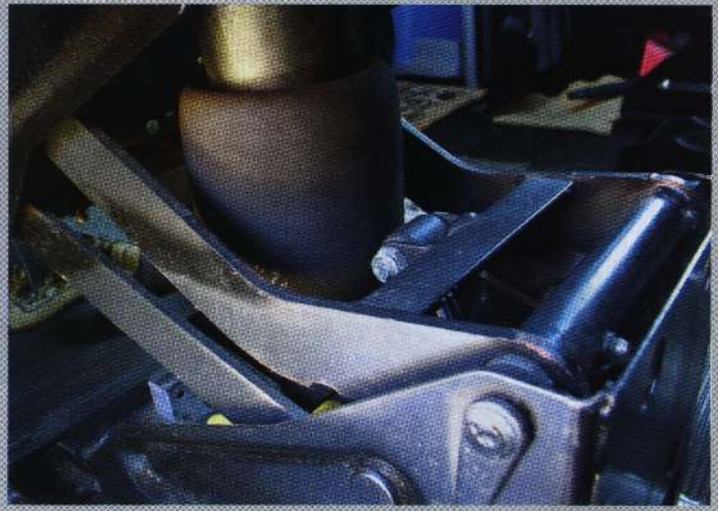
Механизм подвески сидений... смазывается через две пресс-масленки!
